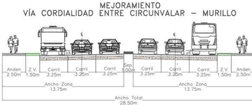
Sección transversal típica entre Cordialidad y Murillo
