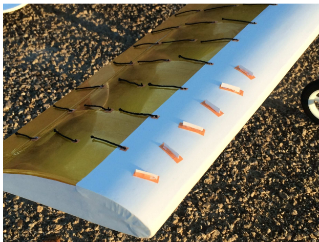
Рисунок 2.7 – Внешний вид установленных на крыло вихрегенераторов. [11]
