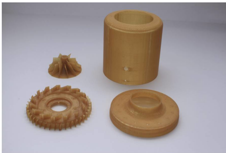
Рисунок 3.5 – Детали конструкции МГТД из термопластика
