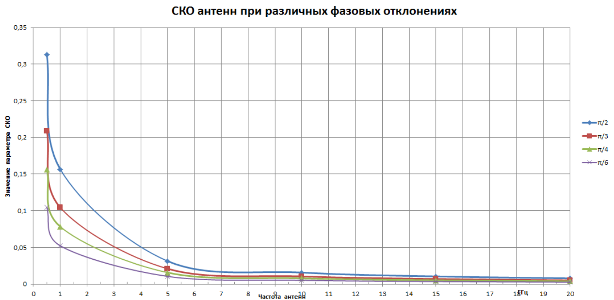
Рисунок 2 – Сравнение значений СКО для антенн с частотами: 500 МГц, 1 ГГц, 5 ГГц, 10 ГГц, 15 ГГц, 20 ГГц при различных фазовых отклонениях
