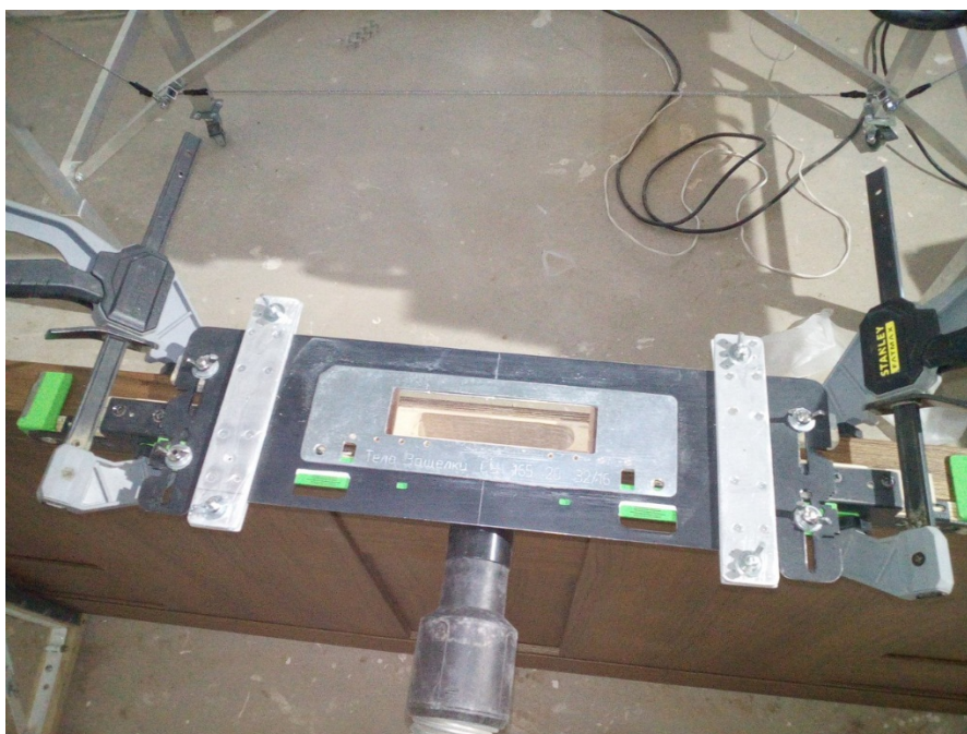
Рисунок 2 – шаблон Павла Солдатова, установленный на дверь.
