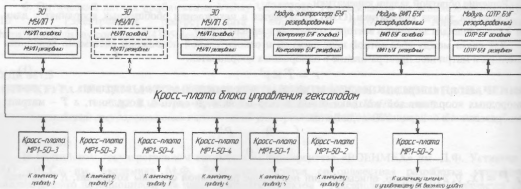
Рис. 2. Схема электрическая структурная блока управления гексаподом
