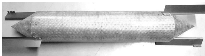
Рис. 4.2 - Цилиндрическая вставка d=150\text{мм} угол раскрытия конуса обтекателя – 60^\circ .
