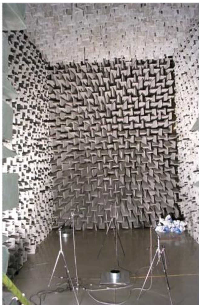
Рисунок 3.5 – Полузаглушенная камера с облицовкой.
