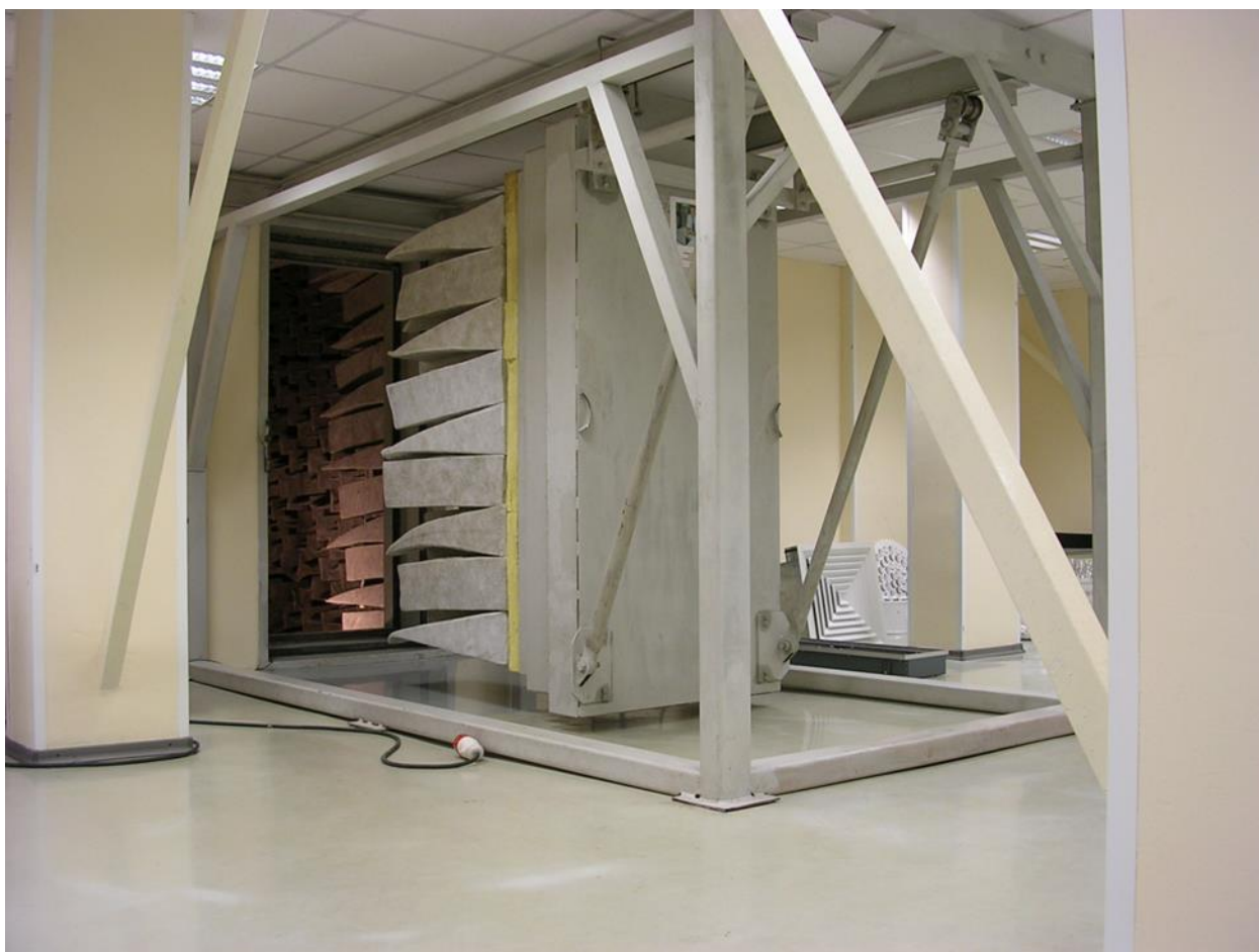
Рисунок 3.6 – Конструкция двери полузаглушенной камеры.
