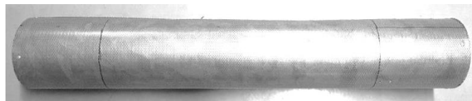
Рис. 4.3 - Цилиндрическая вставка d=150\text{мм} угол раскрытия конуса обтекателя – 180^\circ .
