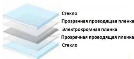
Рис. 1. Состав электрохромного устройства
