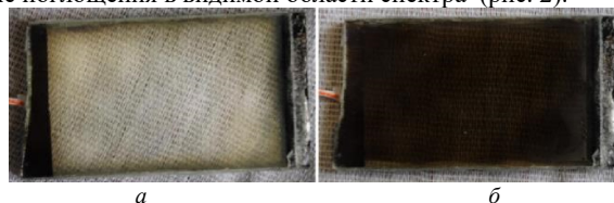
Рис. 2. Электрохромная ячейка: а – обесцвеченное; б – окрашенное состояние
