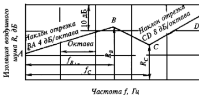
Рисунок 2 - Частотная характеристика изоляции воздушного шума однослойным плоским ограждением из металла или стекла
