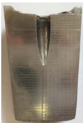
Рисунок 5.1 – Матрица обжима пульных оболочек
