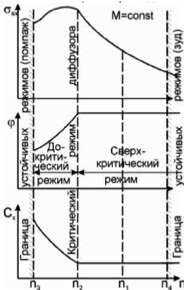
Рисунок 2.11 – Зависимость \sigma_{вх} , \varphi и C_x от приведенного числа оборотов ТРД(Д)
