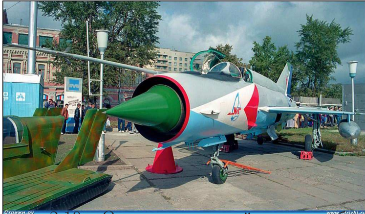
Рисунок 2.10 – Осесимметричный воздухозаборник
