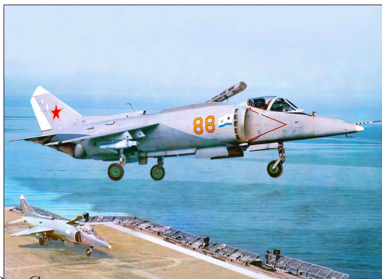
Рисунок 2.3 – Система открытия дополнительных окон на воздухозаборнике, для обеспечения требуемого расхода воздуха
