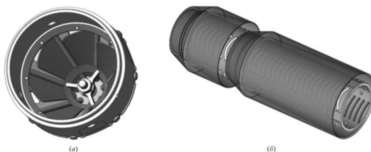
Рисунок 2.13 – Схема лепесткового (а) и газодинамического (б) обратных клапанов
