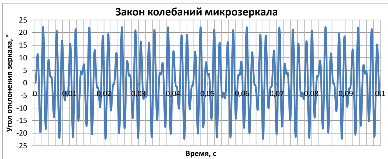
График 1. Зависимость угла отклонения зеркала от времени
