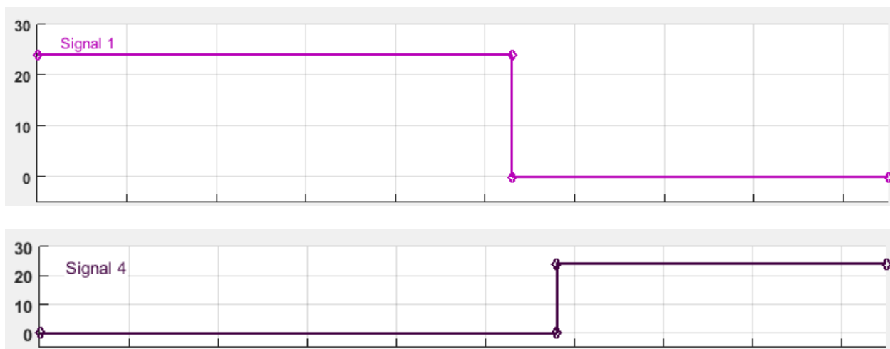
Рисунок 4 – Схема переключения электромагнитов распределителя
