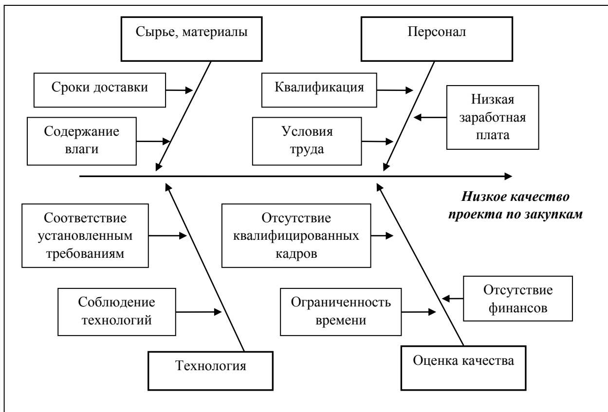
Рисунок 8 – Построение диаграммы Исикавы применительно к процессу закупок
