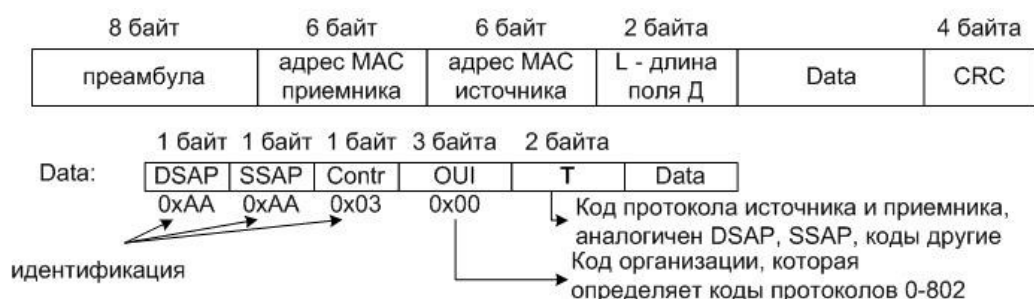
Рисунок 7 - Структура кадра Ethernet
